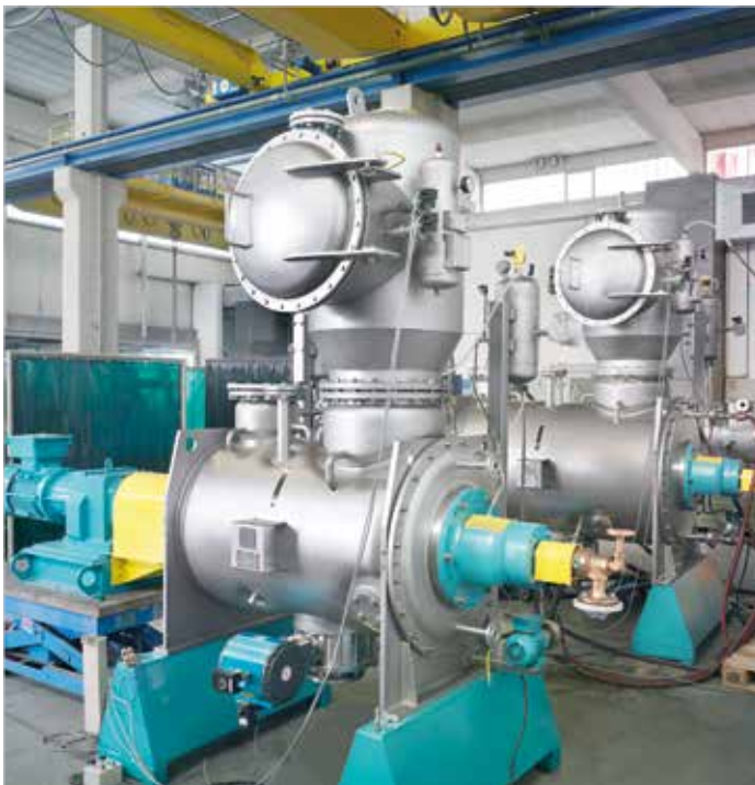
Vakuum-Schaufeltrockner DRUVATHERM® Typ VT 300, mit beheizter Welle
